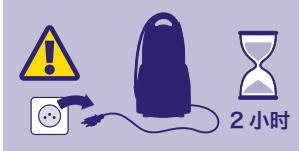
**警告:** 每次清理前请确保设备处于关闭、电源切断和冷却状态。关闭设备并从插座上拔下设备插头。让您的设备冷却至少2个小时。最好是在使用前清洁设备。
