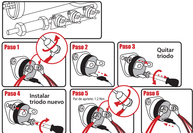
Figure 43 - Cambio del triodo
