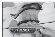
Réglez le Marksman Pro de CAMO à la largeur des planches utilisées. Desserrez la Molette à l'arrière de l'outil pour régler les d'espacement et les ajuster à la largeur des planches. Le réglage médian convient à la majorité des planches, ordinaires ou bouvetées, d'une largeur de 5-1/4 po - 5-3/4 po.
