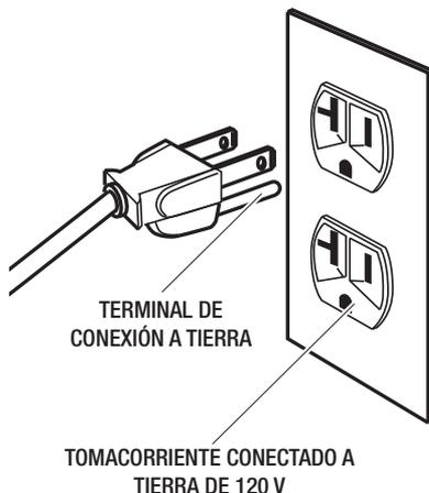
**ADVERTENCIA:** La instalación incorrecta del enchufe de conexión a tierra causará un riesgo de descargas eléctricas. Si es necesario reparar o reemplazar el cable de alimentación o el enchufe, no conecte el cable de conexión a tierra a ninguno de los dos terminales de hoja plana. El cable con aislamiento que tiene una superficie exterior de color verde con o sin franjas amarillas es el cable de conexión a tierra.
