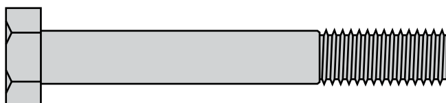
⑦ Vis d'assemblage – M12-1,75 x 65
