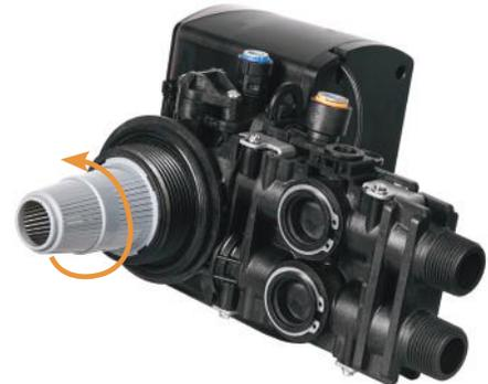
5. Ponga el distribuidor superior sobre el tubo de y empuje la válvula hacia el tanque. Rosque la sobre por el tanque, girando hacia la derecha. La válvula deberá quedar instalada fácilmente en el tanque. Si no sucede, puede que esté mal enroscada.
