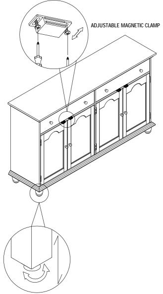
IF THE GROUND IS NOT EVEN ,THE SIDEBOARD WILL BE UNSTABLE OR THE DOORS UNSYMMETRICAL,YOU CAN ADJUST THE FOOT LEVELER UNDER THE LEG.TURN LEFT TO TIGHTEN,TURN RIGHT TO LOOSEN.
