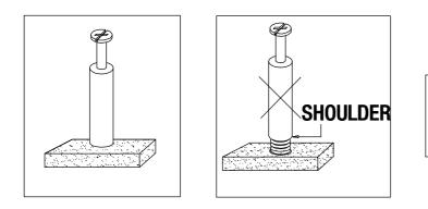
NOTE:TURN THE CAM-BOLT SCREWS UNTIL THEY ARE TIGHT,THE SHOULDER SHOULD BE AGAINST THE SURFACE OF THE PART.
