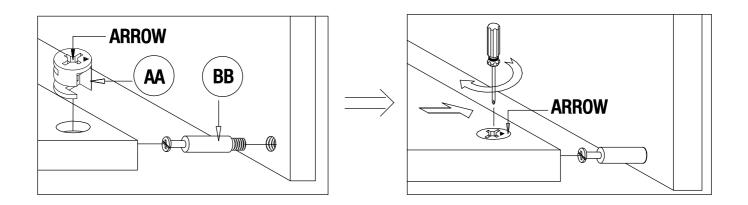
• NOTE: THE ARROWS ON THE HIDDEN CAM-LOCKS SHOULD POINT TO THE CAM-BOLTS.
