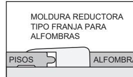
**Moldura reducitora tipo franja para alfombras (también conocidas como sellos de extremo):** Se usan para las transiciones de cubiertas de pisos de diferentes alturas. Esta franja reducitora suele usarse también para bordear una chimenea, una puerta deslizante de vidrio y otras jambas de puertas exteriores.
