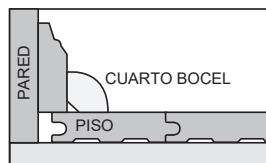
**Cuarto bocel:** Se usa para cubrir el espacio de expansión entre la base de la pared y el piso. También puede usarse para transiciones suaves entre el piso y los gabinetes. Puede usarse con o sin moldura de base de pared.
