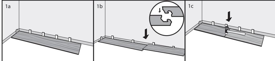
El siguiente tablón se sujetó colocando la lengüeta de extremo corto del siguiente tablón sobre la ranura del tablón precedente. Usando un martillo de cabeza no metálica, golpear con cuidado la unión para juntar los extremos y fijarlos.
