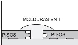
Molduras en T: Se usan para crear una transición entre las cubiertas de piso de alturas similares o para cubrir un espacio de expansión.
