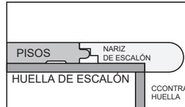
**Nariz de escalón:** Se usa con el piso instalado en los peldaños de las escaleras o bordes acabados de un piso a nivel más alto, como en una sala de estar a nivel más bajo.
