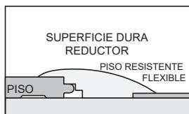
**Moldura reductora de superficies:** Se usan para transiciones a otro piso duro de diferentes alturas, como losa, vinilo o concreto.
