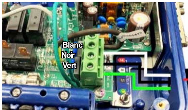
Boîtier de contrôle de 110 volts 30 ampères pour conversion sur le terrain
