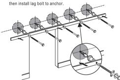
B **Drywall installation.**Install the lag bolt to wood stud
