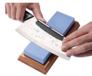
Klicken Sie den Winkelhalter einfach am Messerrücken an, legen Sie die Führung an den Stein an und befolgen Sie dann die oben beschriebenen Anweisungen zum Schärfen von Steinen. Wenn Sie den richtigen Winkel zum Schärfen beibehalten können, können Sie den Winkelhalter entfernen und mit dem richtigen Schärfwinkel manuell beibehalten.
