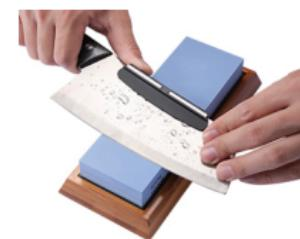
Basta attaccare la guida angolare alla spina dorsale del coltello, appoggiare la guida contro la pietra, quindi seguire le istruzioni per affilare la pietra sopra descritte. Una volta che è possibile mantenere il corretto angolo di affilatura è possibile rimuovere la guida e mantenere manualmente il corretto angolo di affilatura.
