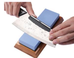
Simplemente coloque la guía del ángulo en el lomo de su cuchillo, apoye la guía contra la piedra y siga las instrucciones de la piedra de afilar que se indican arriba. Una vez que puedas mantener el ángulo adecuado para afilar puedes quitar la guía y manualmente mantener el ángulo de afilado adecuado.
