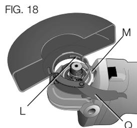
3. Tourner le dispositif de protection (F) pour le mettre à la position de travail désiré. Le dispositif de protection doit être positionné entre la broche et l'opérateur afin d'assurer une protection maximale à l'opérateur.
