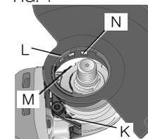
3. Manteniendo abierta la palanca de liberación del protector, empuje hacia abajo el protector hasta que las lengüetas enganchen y gírelas en la ranura del cubo de la caja de engranajes. Suelte la palanca de liberación del protector.
