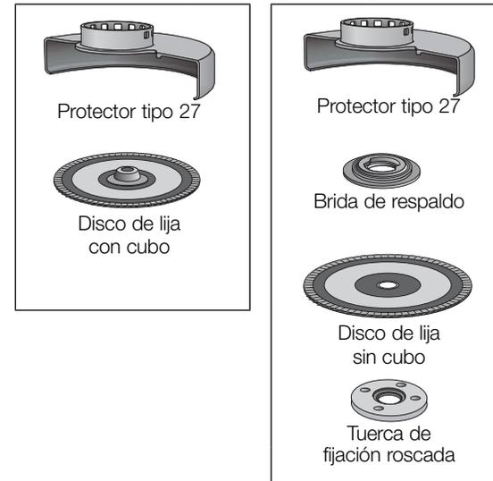
para mandril de 7/8". De no ser así, puede estar diseñado para una sierra circular y no se lo debe utilizar. Utilice únicamente los accesorios que se muestran en las páginas 52 y 53. La velocidad nominal de los accesorios debe ser superior a la velocidad mínima aprobada del disco, indicada en la placa de la herramienta.
