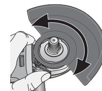
5. Para un ajuste fácil, el protector puede girarse en dirección de las manillas del reloj. **NOTA:** La palanca de liberación del protector debe encajar en uno de los orificios de alineamiento (N) del cuello del protector. Así se garantiza que el protector esté bien instalado. El protector puede volverse a colocar en la dirección opuesta presionando la palanca de liberación del protector.
