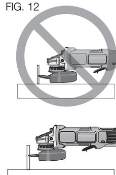
**⚠ ADVERTENCIA:** No utilice discos de corte o para esmerilar bordes para esmerilar superficies, porque estos discos no están diseñados para soportar las presiones laterales que se producen al esmerilar superficies. Se puede quebrar el disco y producir lesiones.
