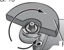
**REMARQUE :** si après un certain temps, le capot de protection (Type 1) se desserrait, resserrer la vis de réglage (R) alors que le levier de serrage est en position fermée.
