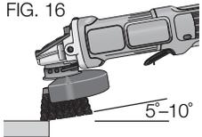
2. Appliquer une pression minimum à la surface de la pièce, ce qui permet à l'outil de fonctionner à une vitesse élevée. Le taux d'enlèvement de matière est supérieur lorsque l'outil fonctionne à une vitesse élevée.
