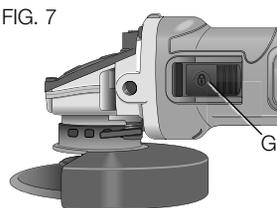
cualquier interrupción de la alimentación eléctrica a la herramienta, como por ejemplo la activación de un interruptor diferencial de tierra, la activación de un cortacircuitos, el desenchufe accidental o la interrupción del suministro eléctrico. Si el interruptor deslizador está en posición de encendido al enchufar la herramienta, ésta se pondrá en marcha súbitamente.
