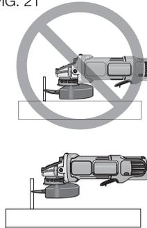
4. Retire la herramienta de la superficie de trabajo antes de apagarla. Permita que la herramienta deje de girar antes de depositarla sobre una superficie.
