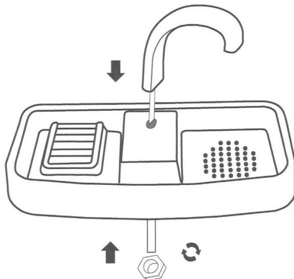
Inserte el tubo del grifo a través de la parte superior del lavabo y complete la asamblea añadiendo la tuerca a través del tubo del grifo y enroscándola en la parte inferior del lavabo.
