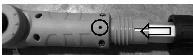
5. Serrer l'accouplement d'arbre B en le tournant dans le sens des aiguilles d'une montre.
