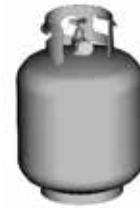
Bouteille en position verticale vers le haut afin de permettre l'évacuation de vapeurs..
