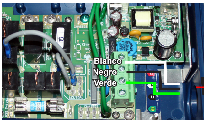
Caja de control de campo de conversión 110 V 30 A
