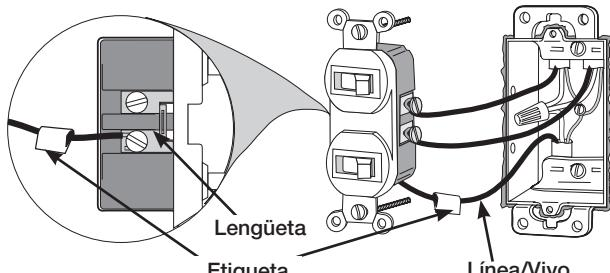
**4 Retire las secciones centrales
