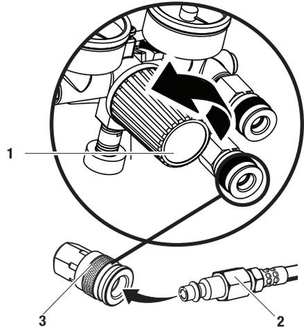
El compresor está ensamblado en la fábrica y listo para utilizarse. Compruebe todos los componentes para asegurarse de que el ensamblaje sea seguro (como por ejemplo: pies de caucho, ruedas, asa, conectores rápidos, manómetros, válvula de seguridad, filtro de aire, válvula de drenaje, etc.).
