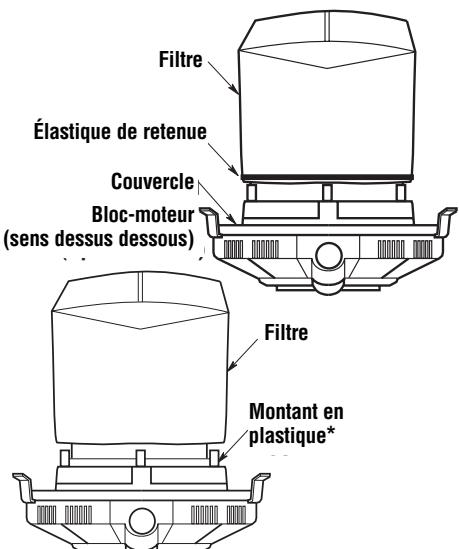
**IMPORTANT :** pour éviter d'endommager la roue de la soufflerie et le moteur, remettez toujours le filtre en place avant d'aspirer des matériaux solides.
