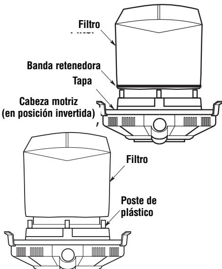
**IMPORTANTE:** Para evitar daños a la rueda del soplador y al motor, reinstale siempre el filtro antes de utilizar la aspiradora para recoger material seco.
