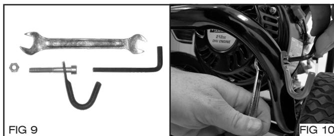
6. Installez le crochet supérieur du pistolet, à l'aide de (1) vis à chapeau à tête creuse M6 x 45 mm de longueur, (1) écrou M6, de la clé hexagonale et de la clé ouverte incluses (FIG 11). Resserrez fermement la vis. Assemblez la baguette en vissant ensemble les connexions filetées des deux parties de la baguette. Suspendez la baguette au crochet supérieur du pistolet, tel qu'illustré à la (FIG 12).
