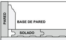
**Mampara redonda:** Usada para cubrir el espacio de expansión entre la base de la pared y su soldado. También se puede usar para hacer transiciones lisas entre el piso y armarios. Se puede usar con o sin moldura de base de pared.
