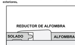
**Reductor de superficie dura:** Usada para transición a otro soldado de superficie dura de alturas diferentes como baldosa, vinilo o concreto.
