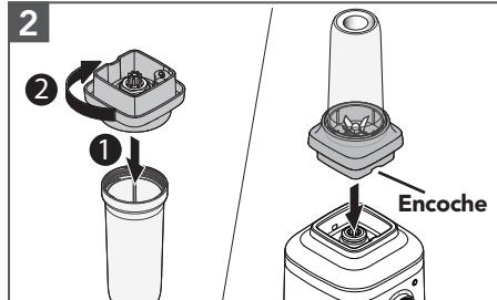
Bien placer la lame sur le pot et faire tourner dans le sens horaire jusqu'à ce qu'elle soit bien serrée. Placer l'ensemble sur le socle.
