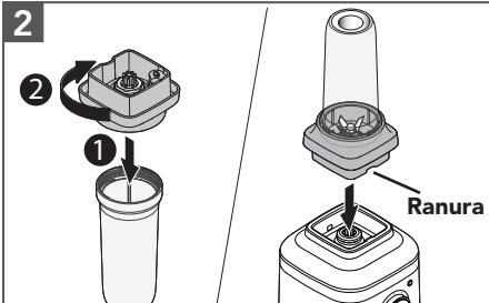
Asegure el ensamblaje de la cuchilla en la jarra y gire en sentido horario hasta que quede ajustado. Coloque la jarra sobre la base.
