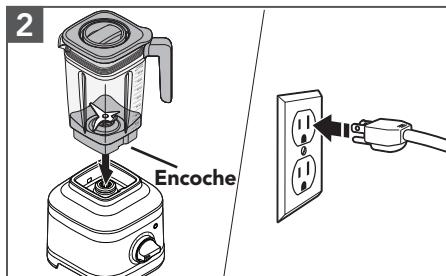
Placer et aligner le pot sur la fente pour introduire à l'intérieur le capuchon inférieur, en orientant la poignée du pot vers le bouton de commande. Brancher le mélangeur sur une prise de courant à 3 alvéoles, reliée à la terre.
