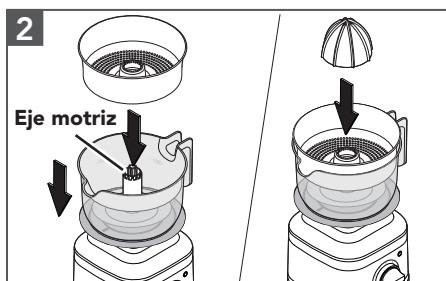
Coloque la canasta para pulpa y luego el exprimidor en el recipiente para jugo, colóquelos alineados con el eje motriz.
