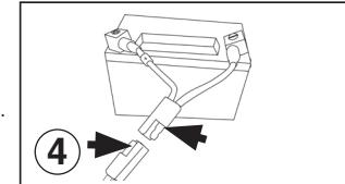
**4. Connect battery.** Conecta la batería. Connectez la batterie.
