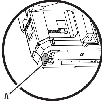
A - Activation foot (contact de déclenchement, disparador de contacto)
