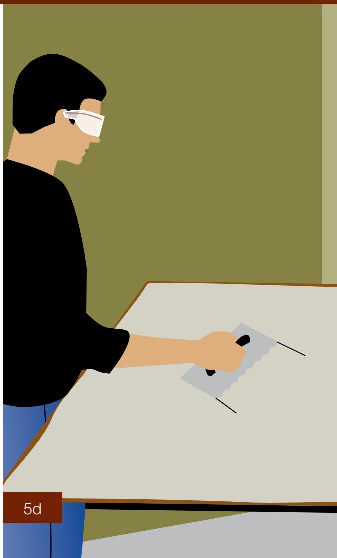
ción. Puede sustituir 6-7 tubos de 10.5 oz. de adhesivo por panel, si la clase aplicable con llana de un galón no está disponible, pero una vez que esté extruido sobre el panel, siempre se debe esparcir con una llana con los dientes adecuados. Siga las instrucciones de seguridad del fabricante. No use clavos en los AquaTiles o PanelBoards.
