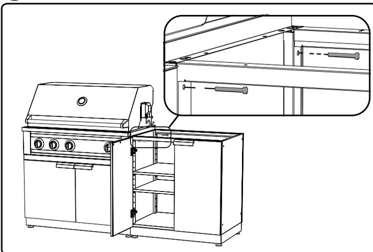
Pour ajouter une armoire supplémentaire, les boulons de 60 mm doivent passer dans les trous de montage des deux armoires.
