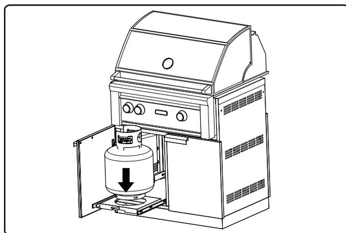
Une fois le plateau de bonbonne est enfoncé à l'arrière de l'armoire, verrouillez le plateau du bonbonne en appuyant sur le bouton de verrouillage. Appuyez sur le bouton de déverrouillage pour le déverrouiller.
