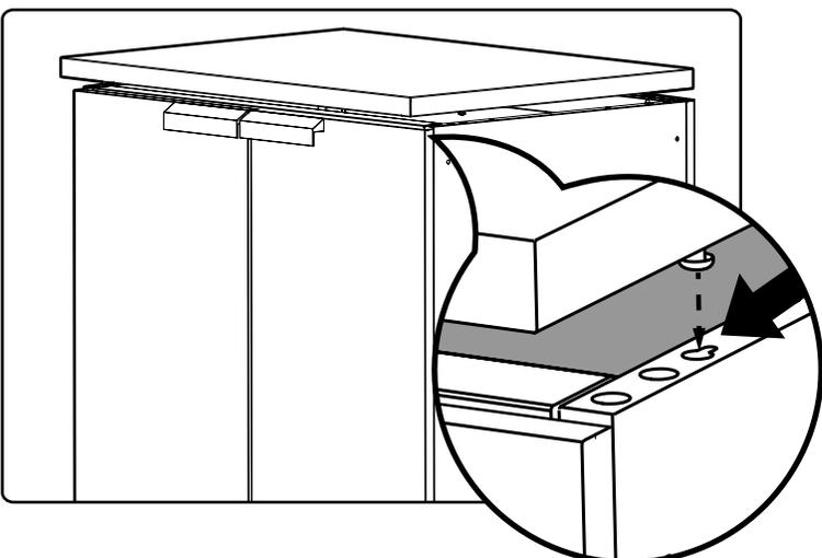
**4** Poussez sur le plan de travail de façon à le verrouiller en place.
