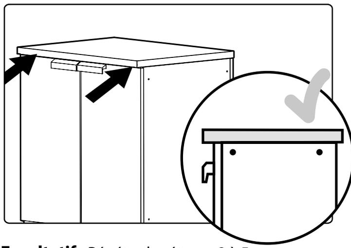
**5** Serrez les vis de manière à attacher les armoires solidement.
