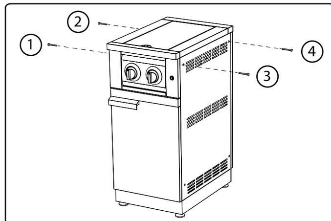
**3** Pour ajouter une armoire supplémentaire, les boulons de 60 mm doivent passer dans les trous de montage des deux armoires.
