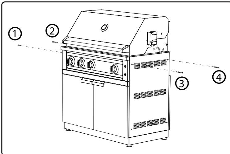
Fixez le barbecue à l'armoire en insérant quatre boulons de 60 mm dans les trous de montage qui s'alignent avec les écrous insérés sur le côté de la boîte à feu du barbecue.
