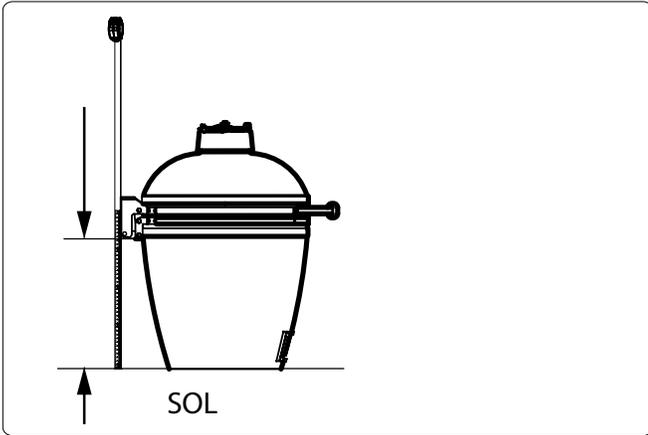
Regler la hauteur de la table d'étape 1. Vérifier que l'anneau métallique est la correct dimension pour votre Kamado par ajustés en glissant vers le haut à partir du bas.
