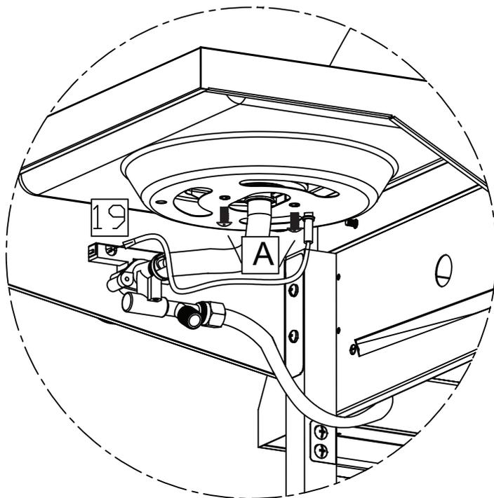
9-2. Une extrémité de l'allumage (19) est fixée à la palette latérale du brûleur à l'aide d'une vis M4 (A) et d'un écrou M4 (D). Fixez l'autre extrémité au connecteur de la valve.
