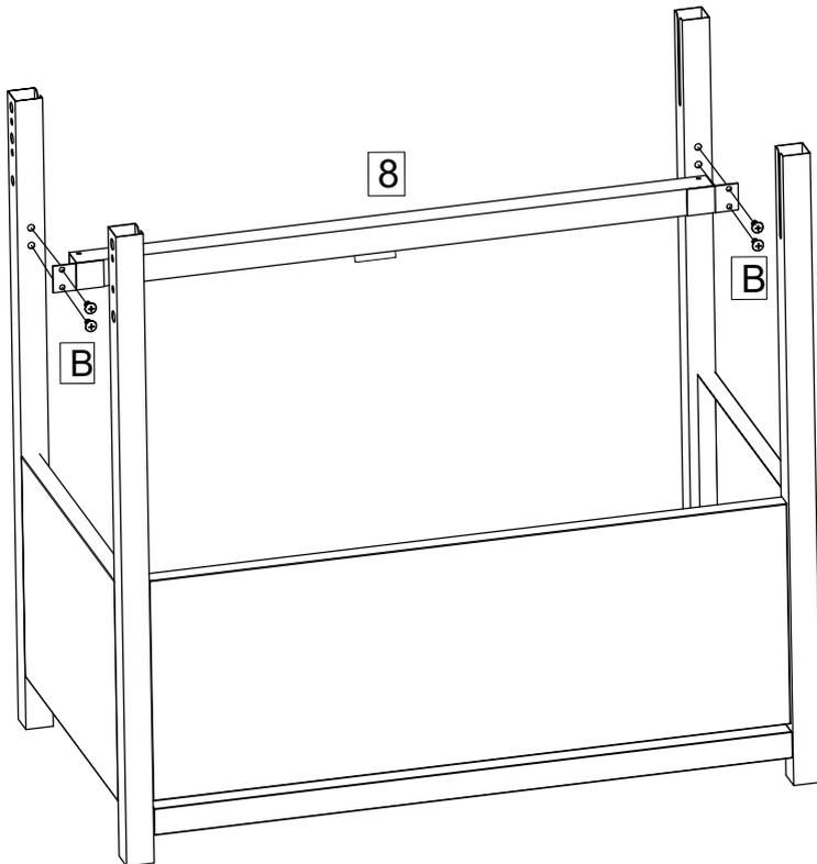
3. Fixez la traverse avant (8) à l'avant des cadres avec quatre vis M5 (B).
