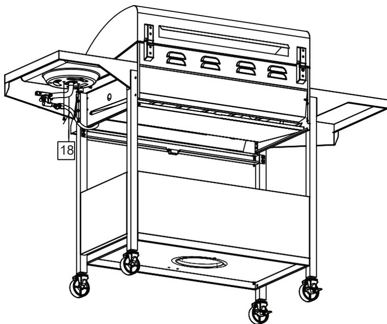
9-1. Le brûleur latéral (18) est fixé à la palette latérale à l'aide de deux vis M4 (A). Insérez le tube dans le connecteur de la valve.
