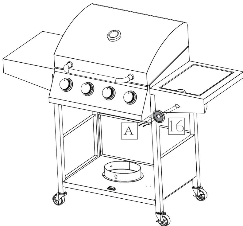
8. La base du commutateur rotatif du brûleur latéral (16), la plaque frontale du brûleur latéral et la valve du brûleur latéral (à l'intérieur de la plaque frontale de la tablette) sont assemblées avec deux vis à tête fraisée M4 (A).
