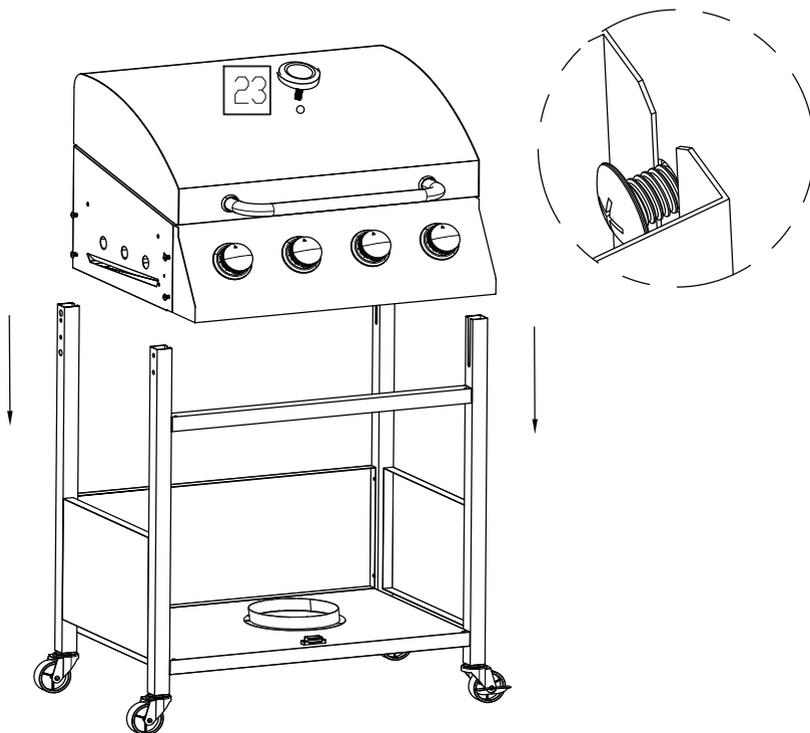
5. Placez le corps (1) dans le cadre à l'aide de huit vis M5 (voir l'image ci-dessus). Serrez les vis une fois que le corps est en position. **REMARQUE** : Assurez-vous que les huit vis sont desserrées avant de les glisser en position.
