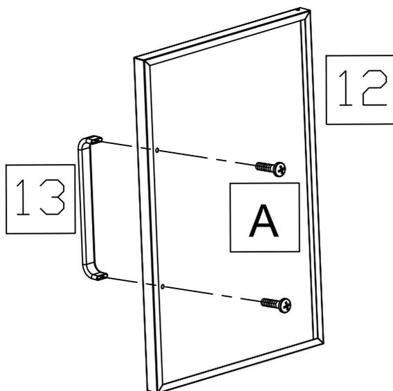
11. Fixez les poignées (13) aux portes avant (12) avec quatre vis M4 (A).
