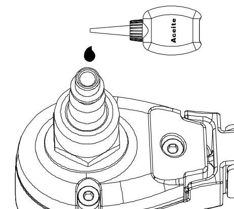
3. Después de agregar el aceite, haga funcionar la herramienta por un breve periodo. Limpie el exceso de aceite de la salida de la cubierta.
