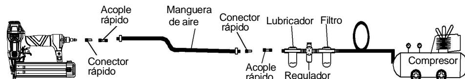
Para obtener un mejor rendimiento, instale un tapón de conexión rápida de 3/8" (rosca NPT de 1/4") con un diámetro interior de 0,315" (8mm) en la herramienta y un acoplador de conexión rápida de 3/8" en la manguera de aire comprimido.
