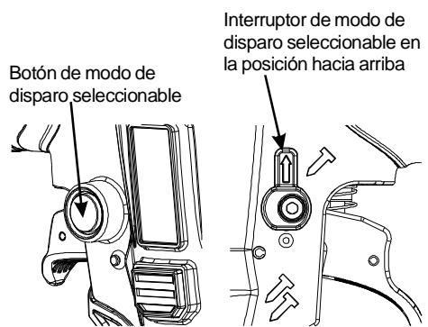
Nota: Primero tirar del gatillo, entonces presione el elemento de contacto de trabajo(WCE) contra la superficie de trabajo, la clavadora NO PUEDE funcionar.
