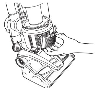
1 Inclinez l'aspirateur vers l'arrière, puis relâchez le loquet pour retirer le filtre d'échappement.
