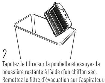
2 Tapotez le filtre sur la poubelle et essuyez la poussière restante à l'aide d'un chiffon sec. Remettez le filtre d'évacuation sur l'aspirateur.
