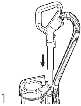
1 Insérez fermement la poignée dans le corps de l'aspirateur.
