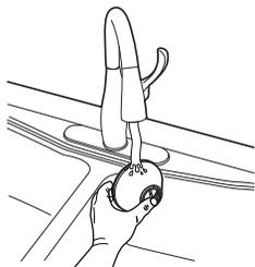
2 Rincez le filtre avec de l'eau uniquement jusqu'à ce que le filtre soit propre et que l'eau soit claire. Pressez doucement le filtre pour enlever l'excès d'eau. Pressez doucement le filtre pour enlever l'excès d'humidité.
