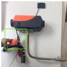
Blaas het luchtpistool naar de inlaatpijp - 14 - om de verbranding te bevorderen
