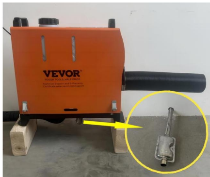
Montaż wewnątrz (rury wydechowe podłóg drewnianych muszą być chronione)
