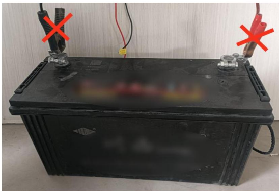
Das Befestigen der Batterieklemme kann leicht zu schlechtem Kontakt führen
