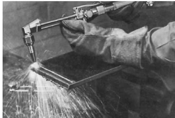
Figure 19. Coupage oxygaz de l'acier
