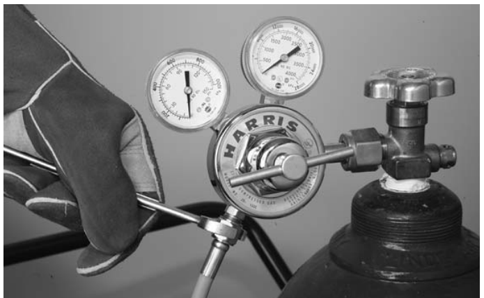
Figure 4. Raccordement du flexible au détendeur
