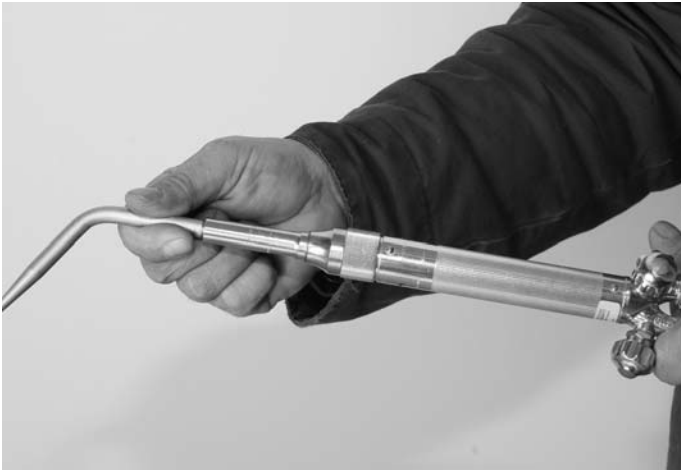
Figure 6. Montage du bec à souder
