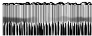
C. Extremadamente lento, produce marcas de presión que indican que hubo demasiado oxígeno para las condiciones de corte.
