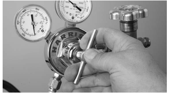
Figure 8. Clé de réglage du détendeur
