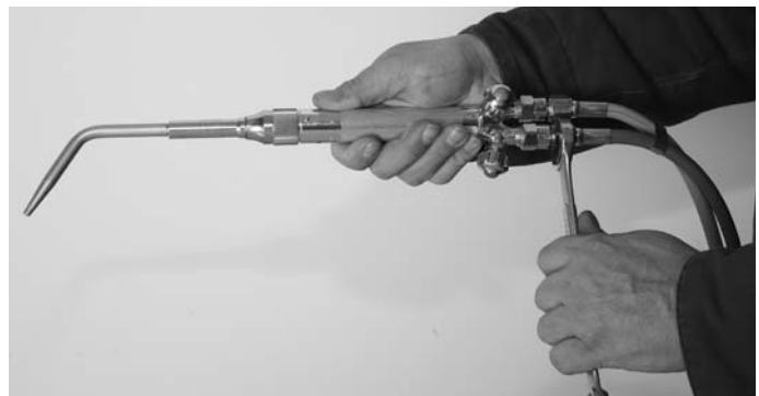
Figura 5. Acoplamiento de la manguera al soplete
