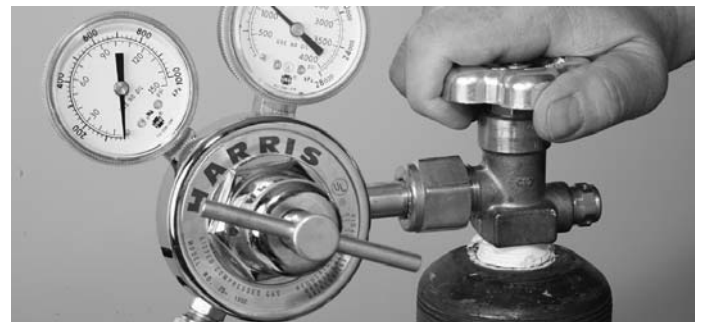
Figure 10. Ouverture du robinet d'oxygène
