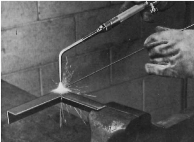
Figura 18. Soldadura con latón
