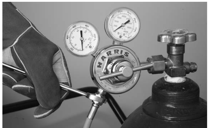
Figura 4. Acoplamiento de la manguera al regulador
