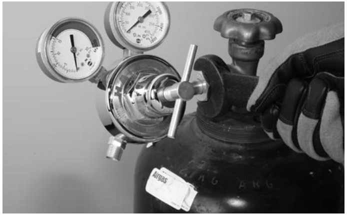
Figura 3. Acoplamiento del regulador de gas combustible
