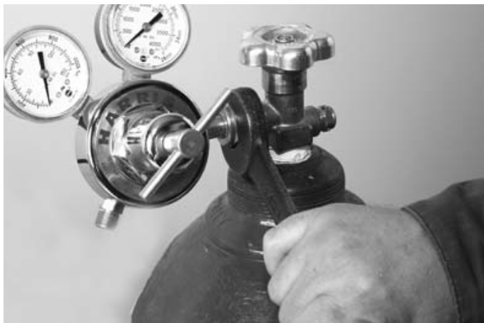
Figure 2. Raccordement du détendeur de l'oxygène
