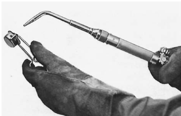
Figure 11. Allumage du gaz combustible
