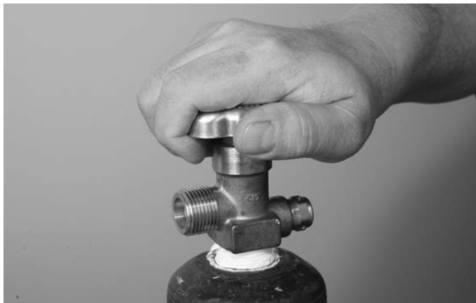
Figure 1. Ouverture du robinet de la bouteille d'oxygène
