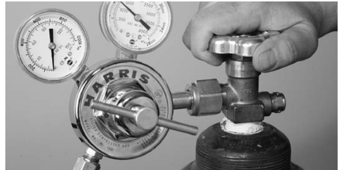
Figura 9. Apertura de la válvula de gas combustible del cilindro
