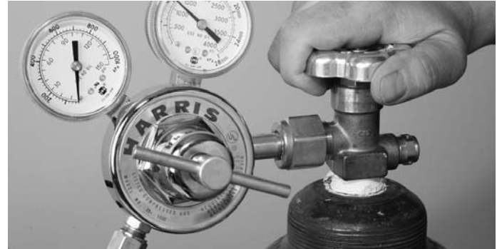
Figure 9. Ouverture du robinet de la bouteille de gaz combustible
