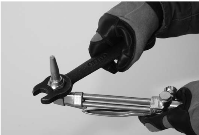
Figure 7. Montage du bec de découpage
