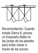
Recomendación: Cuando instale Sierra 8, provea un travesaño doble en las juntas de los paneles para evitar clavar a través de los surcos.
