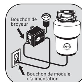
• Branchez le cordon du module d'alimentation dans une prise de courant de 120 V c.a. mise à la terre, réservée qui met sous tension continuellement.
