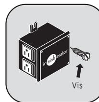
• Montez le module d'alimentation sur un mur d'armoires à **91,4 cm ou 3 pieds** d'une prise de courant et du broyeur.
