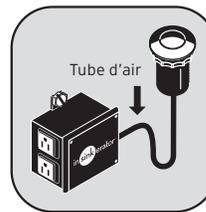
• Installez le tube d'air entre le bouton-poussoir et le module d'alimentation.
