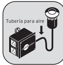
• Conecte la tubería para aire entre el botón y el módulo de energía.
