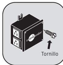
• Monte el módulo de energía en un gabinete de pared a menos de **3 pies (91.4 cm)** de la toma de corriente y el triturador.
