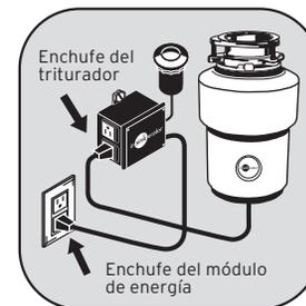
• Conecte el cable del módulo de energía en una toma de corriente dedicada, con conexión a tierra, de 120V CA que reciba corriente en forma continua.
