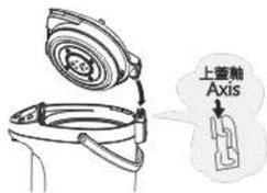
將上蓋尾部之金屬轉軸卡入圖中位置，as shown in the above diagram
