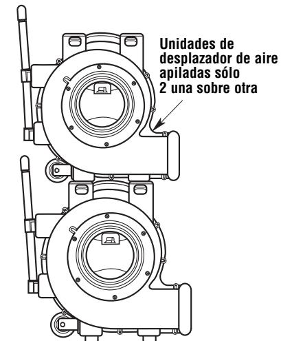
Para transportar las unidades en posición apilada, extienda completamente el mango inferior del desplazador de aire. Agarre firmemente los mangos de cada unidad, incline las unidades hacia atrás y llévelas hasta la ubicación deseada.
