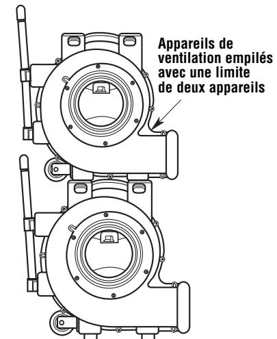
Pour transporter des appareils de ventilation en position empilée, étendez complètement la poignée de l'appareil de ventilation du bas. Saisissez fermement les poignées de chaque appareil et inclinez les appareils vers l'arrière, puis transportez-les jusqu'à l'endroit désiré.
