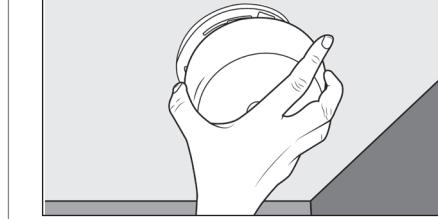
4. Determinare la posizione di montaggio della lampada. Allineare la piastra di montaggio con il soffitto e segnare i fori piloti con una matita. Con il trapano inserire gli elementi di ancoraggio nei fori piloti e allineare la piastra in modo che il lato piatto sia a contatto con il soffitto. Poi inserire le viti nel soffitto.
