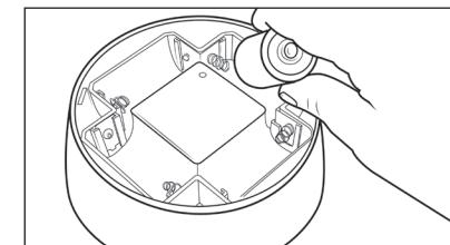
1. Use una mano para estabilizar la lámpara y la otra para desatornillar la placa de las pilas de la lámpara. Coloque un dedo en una de las lengüetas de la placa y gire hacia la izquierda hasta que se afloje. Luego levante la placa para quitarla de la lámpara.
