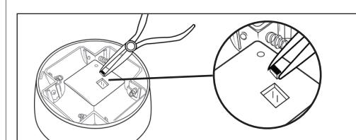
Individuare l'elemento rettangolare nero nella lampada. Rimuovere l'elemento rettangolare nero sollevandolo con una pinza a becchi mezzotondi. Quando l'elemento è rimosso, il sensore di luce non funziona finché il pezzo non venga sostituito. **Attaccare con nastro adesivo l'elemento al retro della lampada per assicurarsi di non perderlo per un eventuale uso futuro.**
