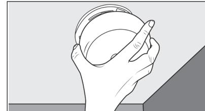
5. Alinee la lámpara con la placa de montaje y haga girar la lámpara hacia la derecha hasta que quede bloqueada en su lugar.
