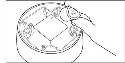
1. Con una mano tener firme la lampada e con l'altra ruotare la piastra del vano batterie staccandola dalla lampada. Agganciare un dito su una delle lingue della piastra e ruotare in senso antiorario fino a liberarla. Poi sollevare la piastra dalla lampada.
