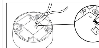
Machen Sie das schwarze, rechteckige Teil in der Leuchte austauschig. Entfernen Sie dieses schwarze, rechteckige Teil, indem Sie es mit einer Nadelzange nach oben ziehen. Sobald das Teil entfernt ist, ist der Lichtsensor deaktiviert, bis das Teil wieder eingesetzt wird. **Befestigen Sie das Teil mit Klebeband an der Rückseite der Leuchte, um es gegebenenfalls später benutzen zu können.**
