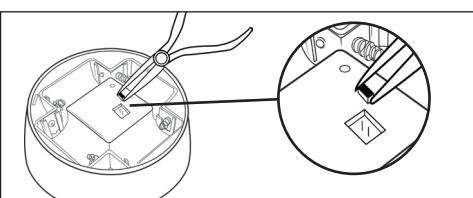
Localice la pieza rectangular negra de la lámpara. Con alicates de punta, levante la pieza rectangular negra y retírela. Cuando se haya retirado la pieza, el sensor de luz no funcionará hasta que se reemplace la pieza. **Pegue la pieza con cinta a la parte trasera de la lámpara para asegurarse de no perderla y poder usarla en el futuro.**
