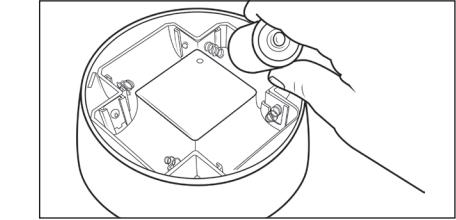
1. Halten Sie die Leuchte mit einer Hand fest und drehen Sie die Batterieplatte mit der anderen Hand von der Leuchte. Haken Sie einen Finger in eine der Längen der Platte ein und drehen Sie so lange gegen den Uhrzeigersinn, bis sich die Platte gelöst hat. Heben Sie die Platte dann von der Leuchte ab.
