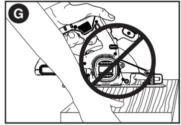
Fije la pieza de trabajo a una plataforma estable, como se muestra en la **figura H**. Es importante sostener el trabajo correctamente para reducir al mínimo la exposición del cuerpo, el atascamiento de la hoja y la pérdida del control.
