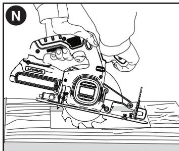
se muestra en la **Figura N**. Ubique su cuerpo y el brazo de modo que pueda resistir el retroceso de la hoja, en caso de que ocurriese.
