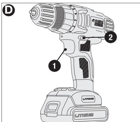
**NOTA:** la posición central del botón de control bloquea la herramienta en la posición de apagado. Al cambiar la posición del botón de control, asegúrese de que el disparador esté liberado.
