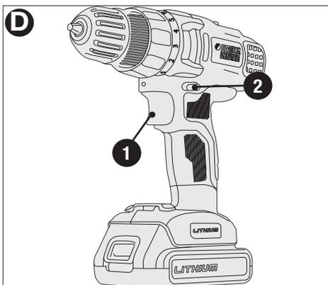
**REMARQUE :** la position du centre du bouton de commande verrouille l'outil en position d'arrêt. Toujours relâcher la détente avant de changer la position du bouton de commande.
