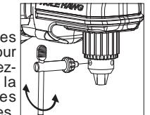
3. Insérez la mèche dans le mandrin. Centrez la mèche dans les mâchoires du mandrin et levez-la à environ 1,6 mm (1/16") du fond. Serrez à la main les mâchoires du mandrin pour aligner l'embout.
