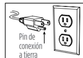
**ADVERTENCIA:** La instalación eléctrica del tomacorriente debe cumplir con las ordenanzas de construcción municipales y con la demás reglamentación aplicable a fin de reducir el riesgo de incendio, descarga eléctrica y lesiones físicas.
