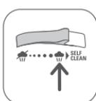
Para planchar con vapor, el ajuste de temperatura deberá encontrarse por encima de la posición •.
