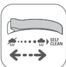
Débranchez le fer, videz l'eau résiduelle et réglez la commande de réglage de la vapeur sur . Ouvrez et fermez plusieurs fois la commande de réglage de la vapeur afin d'empêcher des dépôts de calcaire ou une obstruction de l'orifice d'écoulement dans la chambre de vapeur.
