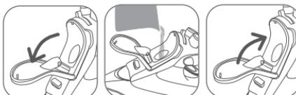
Tenez le fer à repasser en position oblique. Ouvrez l'orifice de remplissage. Versez de l'eau jusqu'au repère max. Fermez l'orifice de remplissage. Vous pouvez mettre le fer de nouveau à l'horizontal.
