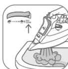
La fonction d'auto nettoyage élimine par rinçage les saletés et les particules de calcaire dans la chambre de vapeur.
