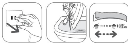
Retirar el enchufe de la red, verter el agua residual y colocar el regulador de vapor en la posición . A continuación, dejar enfriar la plancha.
