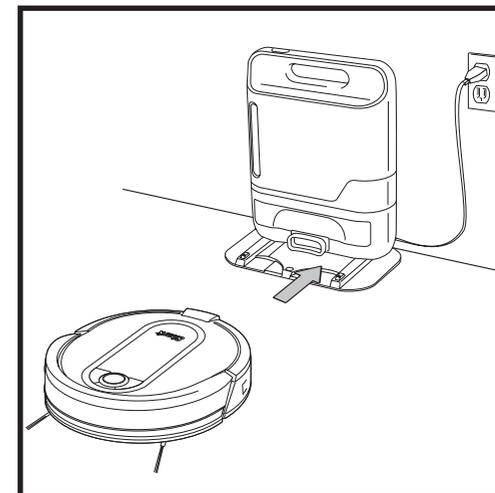
Lorsque le cycle de nettoyage se termine, ou si la batterie est faible, le robot recherchera la base. Si votre robot ne retourne pas à la base, la charge de la batterie est peut-être épuisée.
