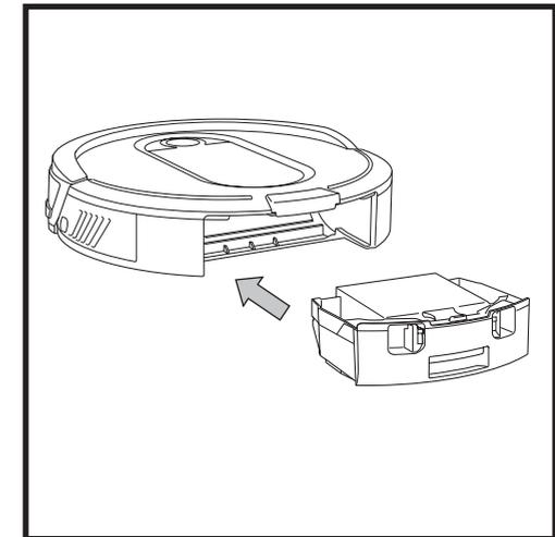
Remettez le filtre dans le réceptacle à poussière du robot, puis remettez le réceptacle à poussière dans le robot en le faisant glisser.
