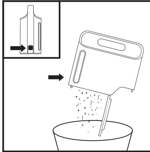
Pour ouvrir le réceptacle à poussière de la base, tenez-le au-dessus d'une poubelle et appuyez sur le bouton **Empty** (vidé) sur le côté.
