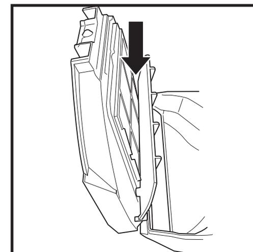
Vérifiez qu'aucun débris ne s'est accumulé entre le filtre et l'écran en plastique.
