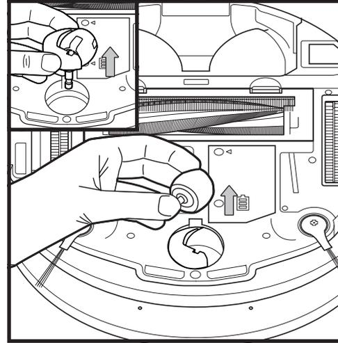
Retirez la **Roulette pivotante avant** de sa cavité et retirez toutes les accumulations de débris.
