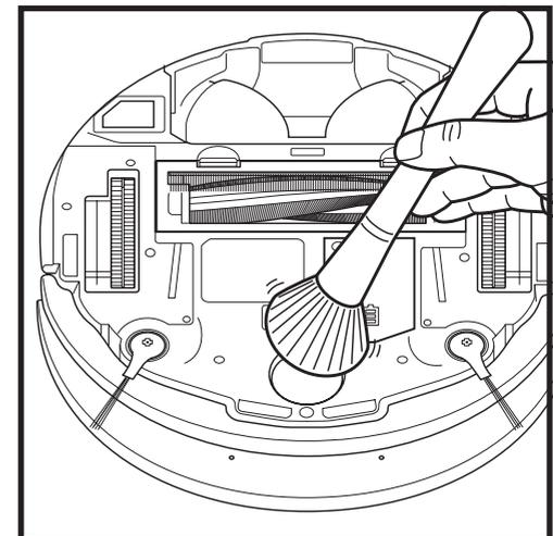
Nettoyez la cavité, avant de réinsérer la roulette.
