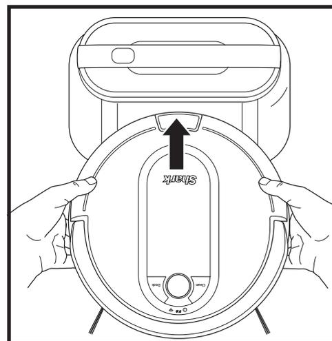
Si le robot n'a plus de charge et que le robot ne peut pas retourner à la base, placez-le vous-même sur la base. Le voyant indicateur clignote bleu et le robot émet un signal sonore lorsqu'il commence à charger.
