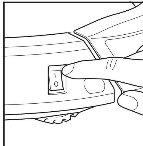
Pour charger, mettez le bouton **Power** (mise en marche) situé sur le côté du robot à la position ON (marche) (I). Le robot émettra un bip lorsque la charge commence.
