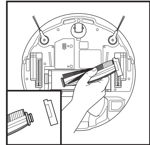
Soulevez la brosse rotative. Retirez le couvercle de l'extrémité de la brosse rotative. Nettoyez les poils et autres débris, puis replacez le couvercle.
