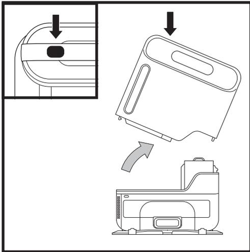
Le **réceptacle à poussière de la base** contient jusqu'à 30 jours de poussière et de débris. Videz le réceptacle lorsque le niveau de débris s'approche de la ligne de remplissage maximal.
