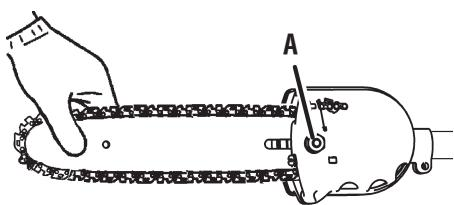
A - Bar nut (écrou du guide, tuerca de la barra)
