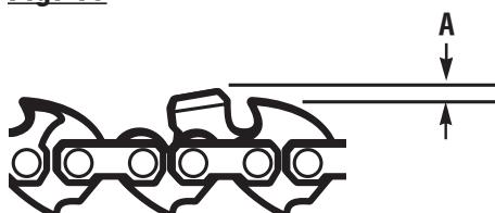
A - Depth gauge setting, (réglage du limiteur de profondeur, ajuste del calibrador de profundidad)
