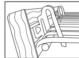
Coloque los extremos abiertos de los fijadores sobre el alambre delantero superior de la repisa (ajuste los fijadores según sea necesario para que no estorben los alambres de la repisa) y empuje el ribete de madera hacia abajo en la posición correspondiente.
