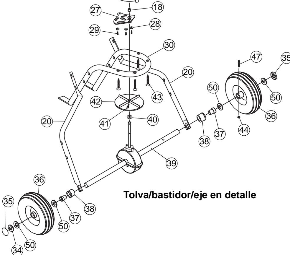
**Tolva/bastidor/eje en detalle**
