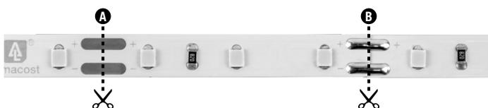
**IMPORTANT:** Toujours utiliser les indicateurs + / - imprimés sur le ruban lumineux pour conserver la même polarité (+ à + et - à -).
