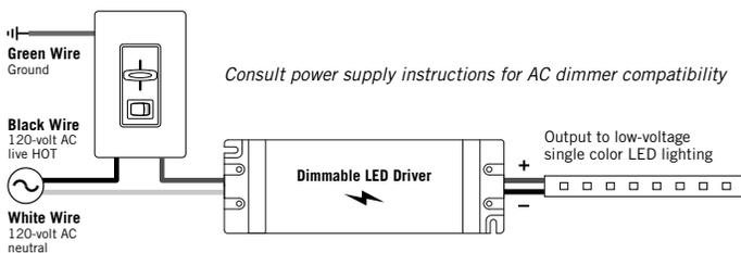
Lors de l'utilisation d'un gradateur pour CA de 120 volts, l'alimentation électrique DEL à intensité variable doit être directement relié à l'électricité résidentielle.
