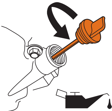
Figure 6 - Remplir l'huile à moteur
