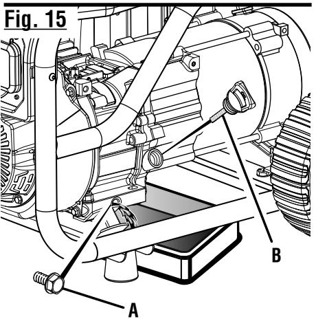
A - Oil drain plug (huiler le bouchon d'égout, tapón de drenaje del aceite)
