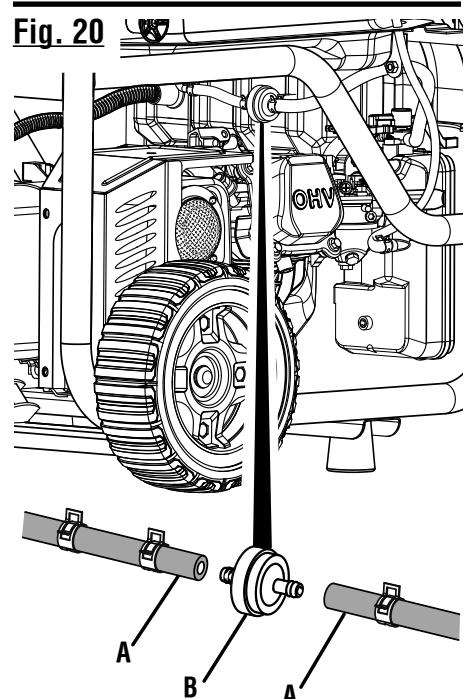
A - Fuel line (conduite de carburant, conducto de combustible)
