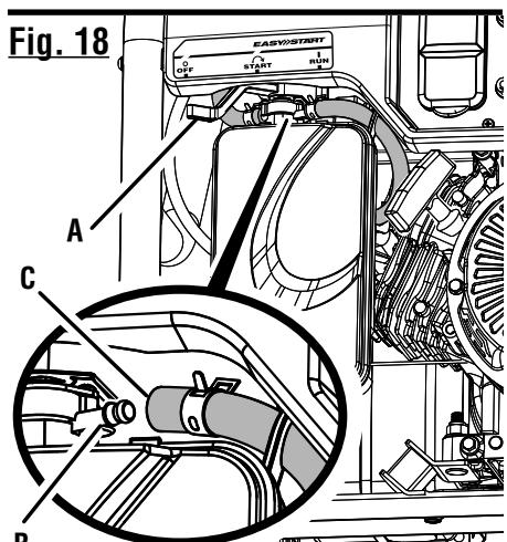
A - Engine switch/choke lever (interrupteur du moteur/levier d'étrangleur, interruptor del motor/palanca del anegador)
