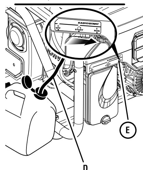
D - Drain line (tuyau de vidange, conducto de drenaje)
