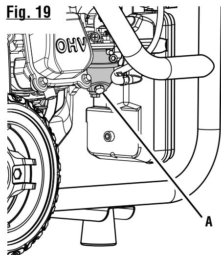
A - Carburetor drain screw (vis de vidange du carburateur, tornillo de drenaje del carburador)
