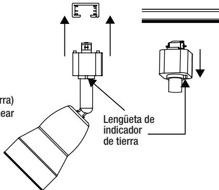
**PRECAUCIÓN:** El adaptador está diseñado para trabarse en el riel cuando gire el adaptador en una sola dirección solamente. Gire la lengüeta "ground indicator" (indicador de tierra) en el riel para alinear la lengüeta a tierra con el conductor a tierra ubicado adentro del riel.
