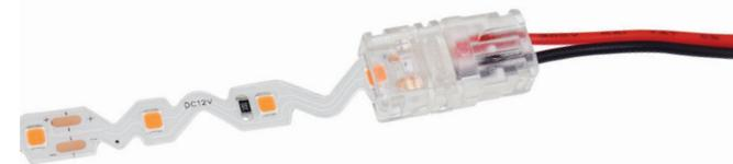
Utilisez un WireGrip en combinaison avec des fils conducteurs soudés en usine, ou utilisez deux connecteurs WireGrip en connectant chacun à chaque extrémité de la bande. Mesurez l'espace et coupez une longueur de fil pour remplir cette distance. Un fil de calibre 22 à 18 est généralement recommandé. Ne torsadez pas l'excès de fil. Une longueur plus courte et des fils plus épais occasionneront moins de baisse de voltage et permettront une plus grande luminosité.
