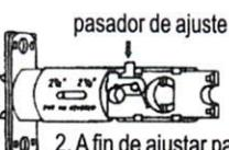
2. A fin de ajustar para 2-3/4" (70mm) empuje hacia abajo sobre el pasador de ajuste y jale Cuando este extendido, el pestillo ahora queda fijo para una distancia de 2-3/4" (70mm)
